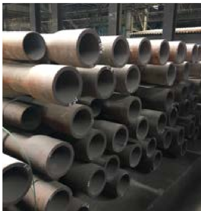
Fig. 2 - Tubos em aço dúctil
