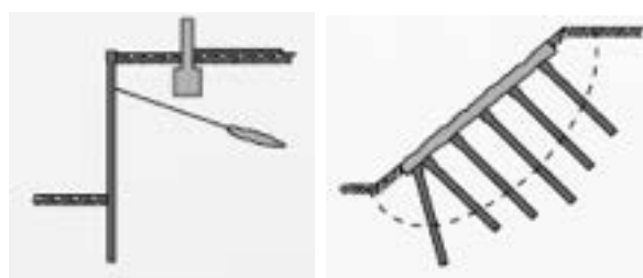
Contenção e estabilização de taludes
