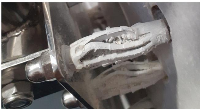
**Figura 8:** Arrancamento de bucha e parafuso.
