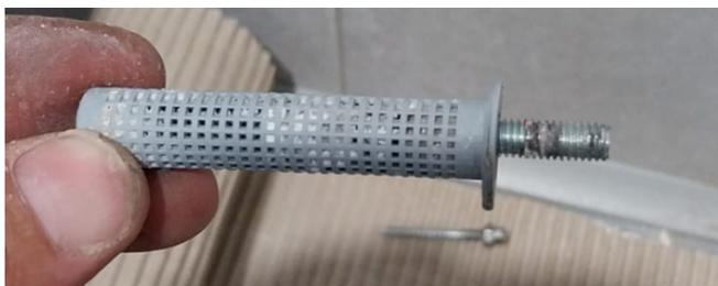
**Figura 9:** Arrancamento de fixação por bucha química.
