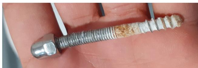
**Figura 6:** Parafuso de fixação de um equipamento suspenso, deformado na sequência da carga que lhe foi aplicada.
