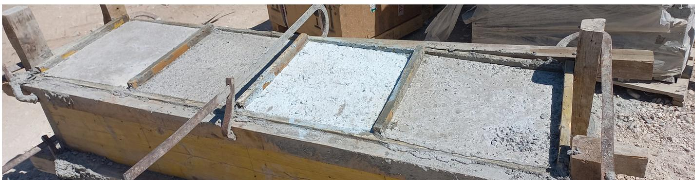
**Figura 4:** Simulação de aderência e execução entre diferentes tipos de acabamentos de superfície de betão.
